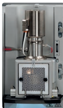
▲ Автоочистка Система автоочистки LECO чистит трубку сжигания и пылевой фильтр.
